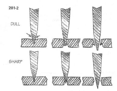
SHARP HOT CUTTING TOOLS MAKE A CLEANER CUT THAN DULL ONES. DULL TOOLS LEAVE A LARGER BURR.
